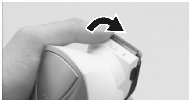
①刃の根元に指をあて、矢印の方向に押し出します。(ケガをしないよう注意)
