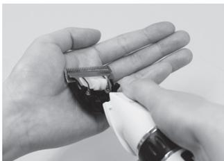
① 刃の根元に指をあて、矢印の方向に押し出します。
